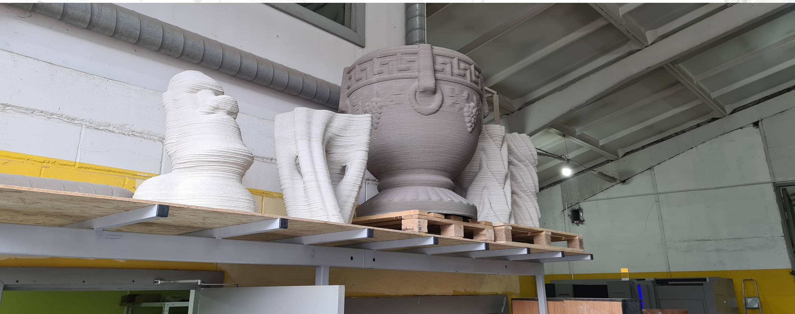
МАФы напечатаны на принтере PBC 3Д
